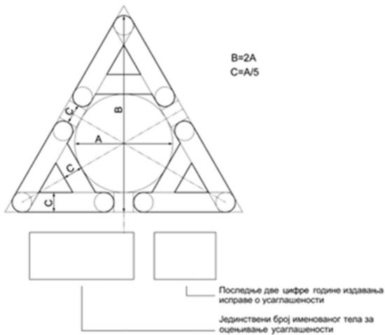
Veličina znaka određuje se prema visini V znaka koja može da ima samo zaokružene vrednosti standardnih brojeva prema redu veličina R10 izraženih u milimetrima (mm) prema srpskom standardu SRPS A.A 0.001 Standardni brojevi - Redovi standardnih brojeva.
